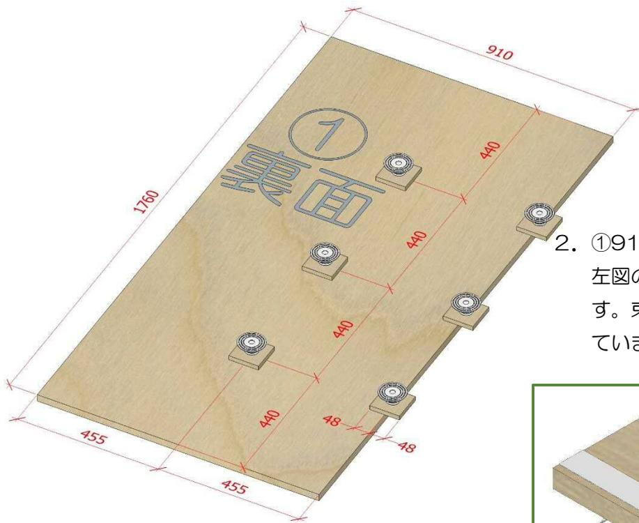
2. ①910×1760の24mm合板の裏面に左図の位置に合わせて束柱を貼り付けます。束柱上面には両面テープが貼り付けています。
