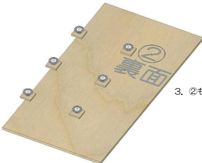
3. ②も同様に 24mm 合板の裏面に束柱を貼り付けます。
