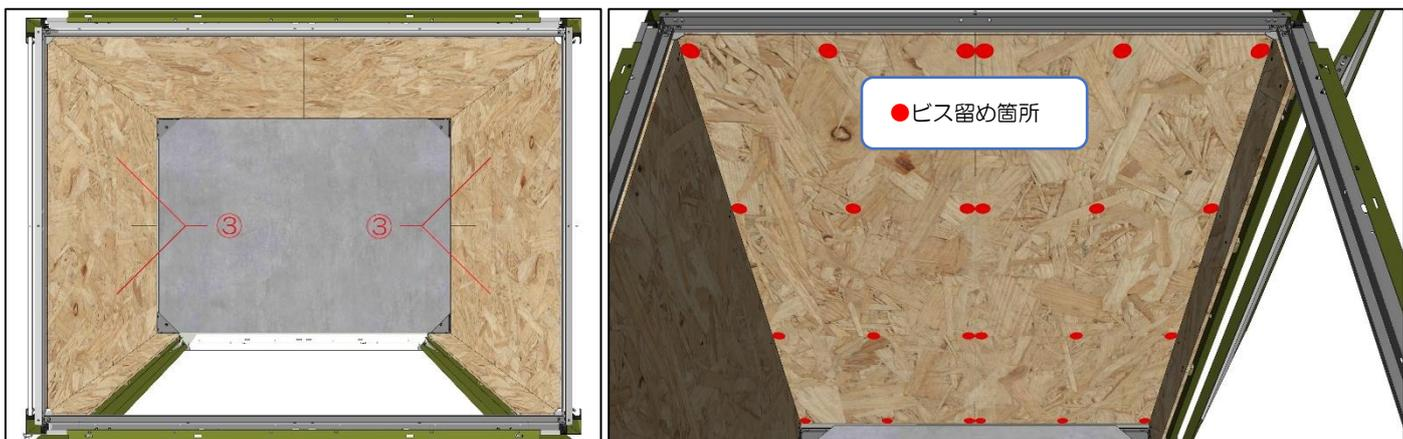
8. TM1HF の扉両袖壁端部に OSB 合板 (④番) を、TM1HF ベース天端から 24mm 離して取付けます。④番の OSB 合板と高さを揃えて、付属の 3.3 × 25 木ビスを使用して、16 × 40 胴縁にビス打ちしてください。
