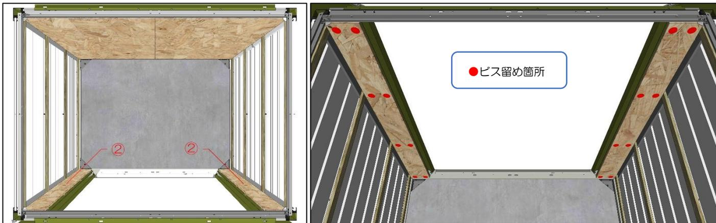
7. TM1HF の両横壁に OSB 合板 (③番) を、TM1HF ベース天端から 24mm 離して取付けます。①、②番の OSB 合板と高さを揃えて、付属の 3.3 × 25 木ビスを使用して、16 × 40 胴縁にビス打ちしてください。
