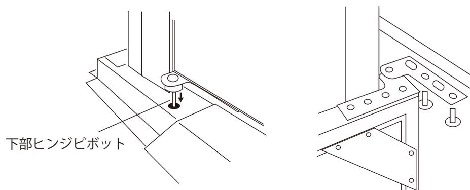
左右のドアがずれている場合は、ヒンジ取付のボルトを緩めて、左右どちらかにスライドさせ調整します。
