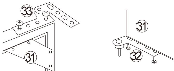
6c. ドアを持ち上げ、下部ヒンジピボットをベース穴に差し込みます。
