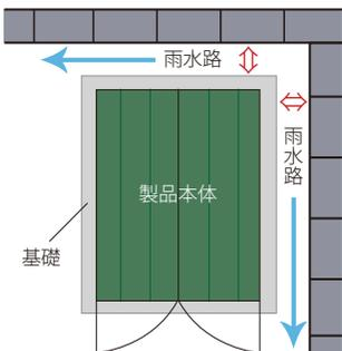
ブロックフェンス際に製品を設置する場合、コーナー部分の排水を考慮して下さい。製品内への雨水侵入を防ぐために、雨水路のスペースを空けて下さい。基礎は左ページ[A]内高基礎を推奨しておりますが、[B]フラット基礎の場合はウッドフロア（オプション品）で床を上げて下さい。
