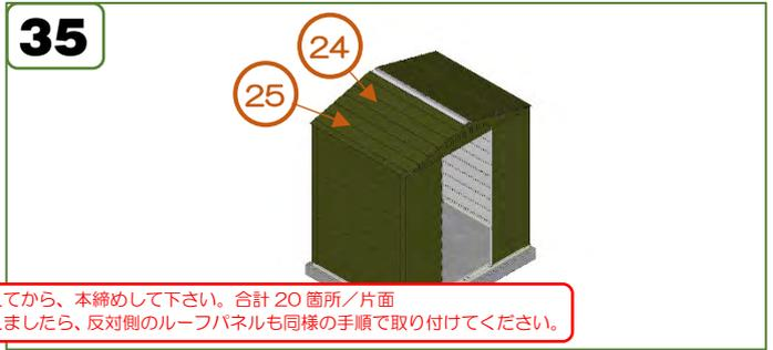
全てのボルトナットを仮固定し終えてから、本締めして下さい。合計 20箇所/片面
